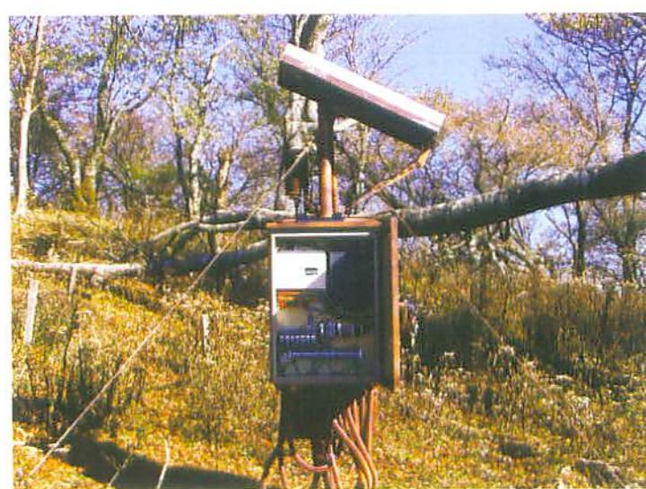
写真3 テレメータ気象観測装置(檜洞丸)
