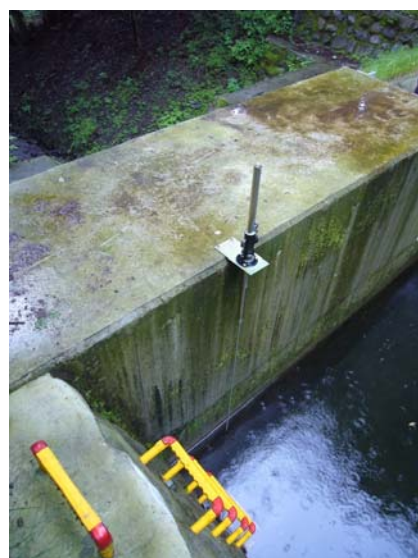
写真4 ポイントゲージ設置状況（左：N03 量水堰 中：N01 量水堰 右：N04 量水堰）
