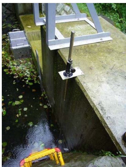
写真4 ポイントゲージ設置状況（左：N03 量水堰 中：N01 量水堰 右：N04 量水堰）
