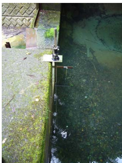
写真4 ポイントゲージ設置状況（左：N03 量水堰 中：N01 量水堰 右：N04 量水堰）
