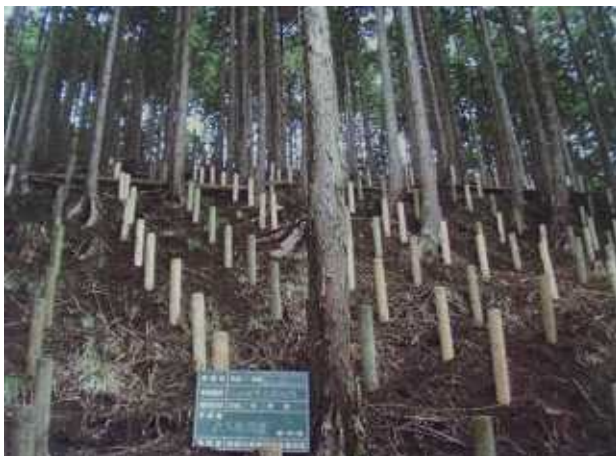
写真-1. 長期野外暴露試験状況
