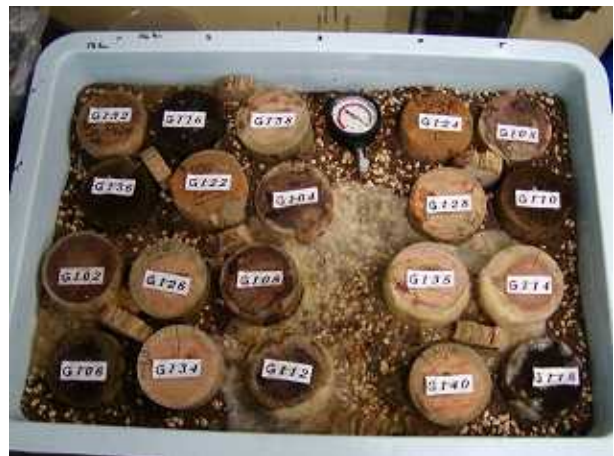
写真-2. ファンガスセラ－試験状況
