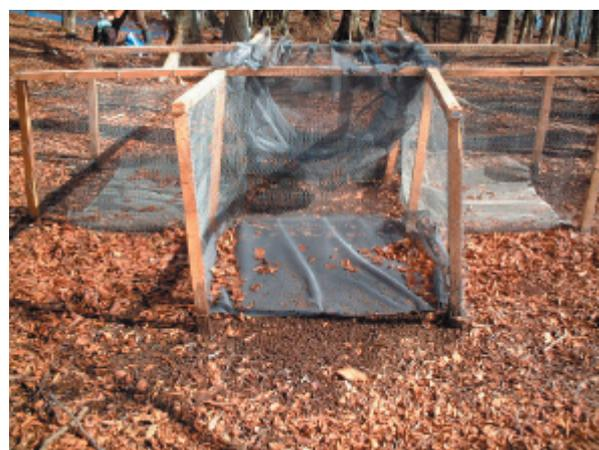
写真5. リター移動量測定柵（斜面下部）
