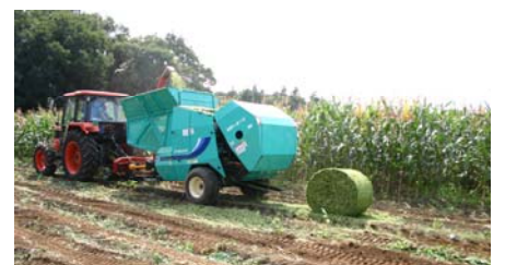
飼料用とうもろこし刈り取り作業 （機械後方にロール状の草を放出）
