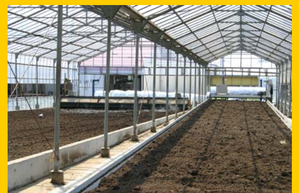
③ たい肥化ハウス (ふんのかく拌移送装置つき) 写真は特に県畜産技術センターで開発された方式のもの
