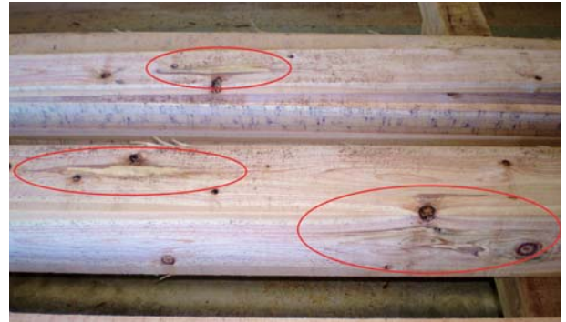
写真5-10 被害材の製材状況(左)と柱材表面の被害の発現状況(右、赤丸内) 被害は柱材の2面以上で出る場合があるが、1面しか出ないか全くない場合もある。
