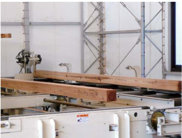
写真5-11 グレーディングマシンによる柱材の強度(左)と含水率(右)測定
