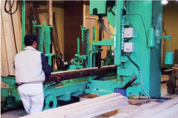
写真5-10 被害材の製材状況(左)と柱材表面の被害の発現状況(右、赤丸内) 被害は柱材の2面以上で出る場合があるが、1面しか出ないか全くない場合もある。
