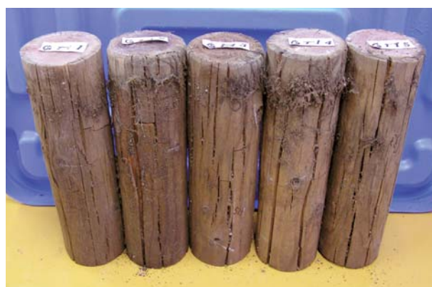
写真4-2 試験前後のスギ被害材と健全材 上から被害材の試験前と試験後、健全材の試験前と試験後。 被害材では変色部を黒いマジック、腐朽部を赤いマジックで囲っている。
