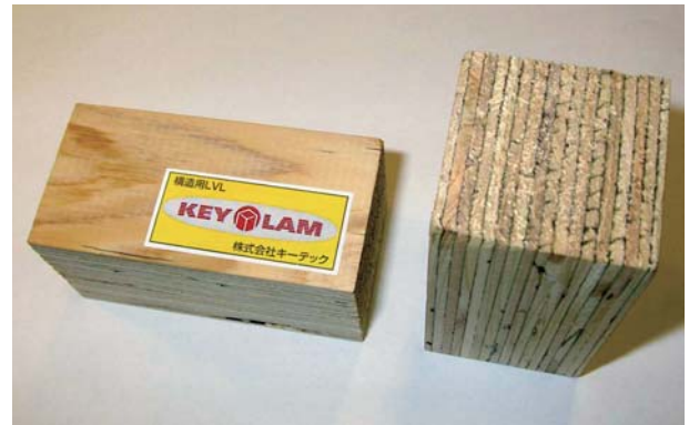
写真5-6 LVLの製品サンプル （17枚の単板、幅5cm×厚さ5cm×長さ10cm）
