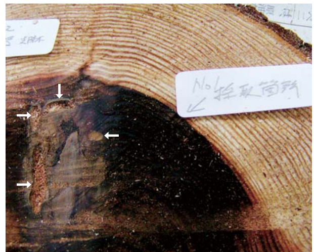
写真3-1 スギ間伐材木口面に現れた食害痕(白い矢印)と食害及び侵入した菌類による変色被害 幼虫の食害痕周辺に変色が広がっている、また変色部右上部分には Acrogenospora sphaerocephala の菌糸蔓延が観察された
