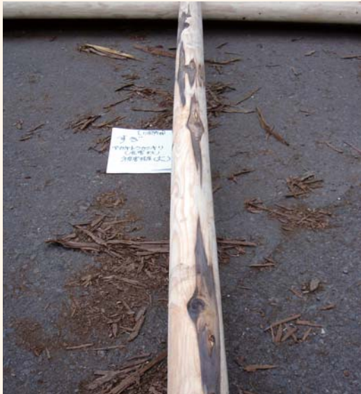
写真1-3 節のある場所に飛び飛びに現れる被害
