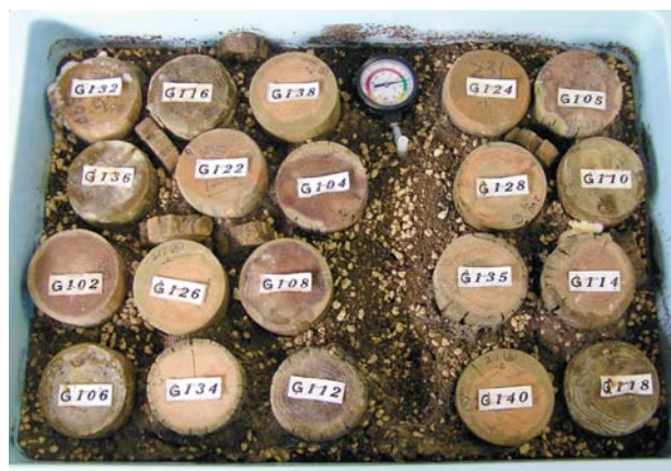
写真4-1 ファンガスセラー試験中の杭丸太(埋込後1年経過した状態)
