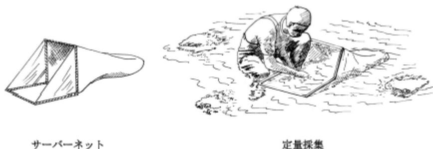
図 3.3(1) 底生動物の調査方法(定量採集)
