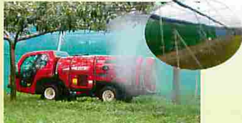
ナシ園防除における漂流飛散 (ドリフト) 低減対策試験
